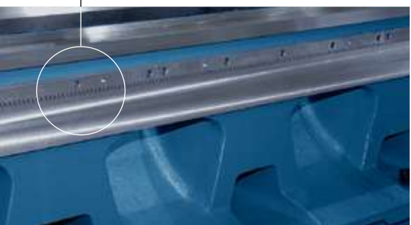
Cremallera del sistema de movimiento de la contrapunta.
