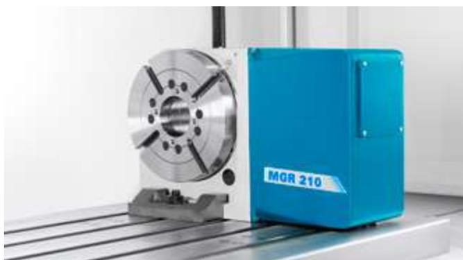
Esta opción le permite mecanizar piezas en todos los ángulos con una Interpolación continua. Garantiza un posicionamiento muy preciso y la repetibilidad del plato. Su robustez y rigidez aseguran una excelente absorción de vibraciones. Para el mecanizado de piezas largas, el contrapunto se puede proporcionar como una opción.
