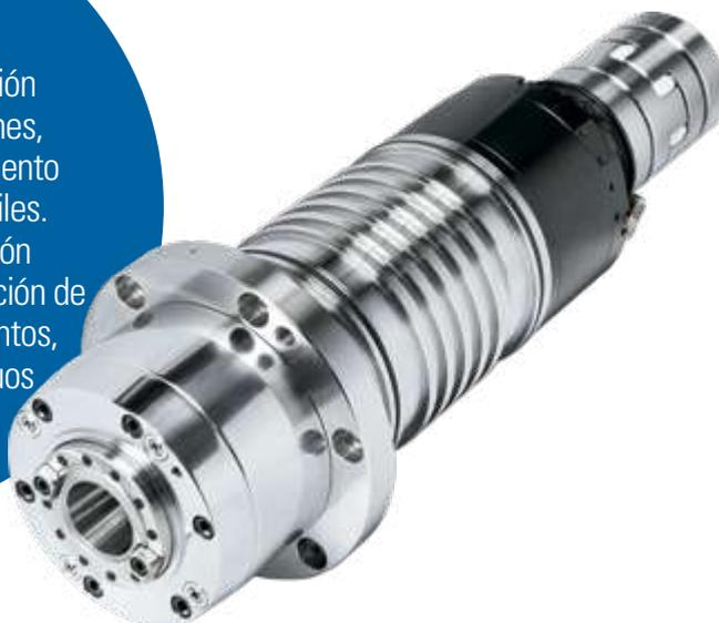
El cartucho se puede equipar con un sistema de refrigeración de enfriamiento del husillo (opcional). Para el cabezal versión de 15.000 rpm es estándar, este sistema contribuye a la estabilidad térmica y geométrica del conjunto.
