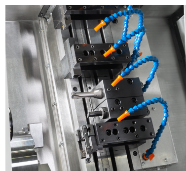
Sistema Gang Tools para portaherramientas: inclinación de 60°, fácil acceso del operador a los portaherramientas y evacuación de virutas.
